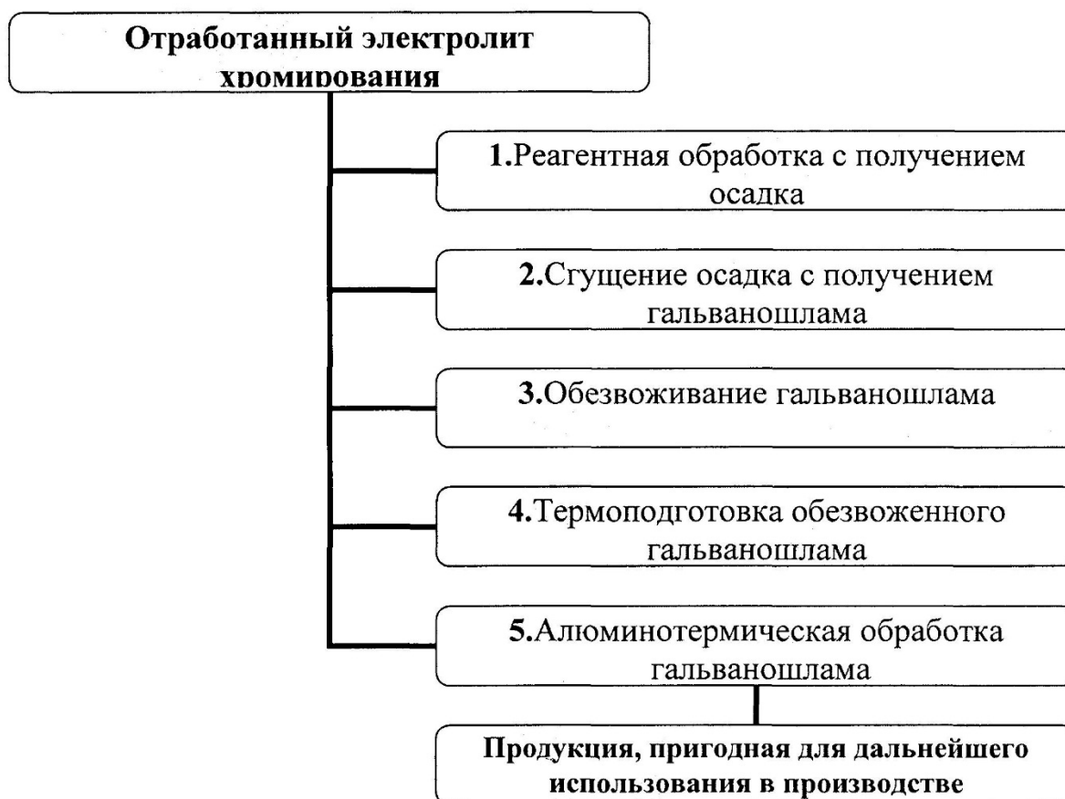
Технологическая схема утилизации хромсодержащих электролитов
